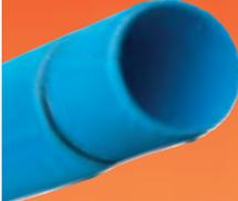
Aplicamos Tubos e Filtros da **TUBOFURO** em **PVC GEOROSCADO**, de 140 a 400 mm e até 1100 mm em aço, próprios para captação de águas subterrâneas, de alta produtividade, específicos para furos tubulares. A TUBOFURO desenvolveu uma linha de tubos e filtros de cor azul, lisos no interior e estriados longitudinalmente ou lisos no exterior cujo sistema de acoplamento é feito através de roscas trazoidais.
