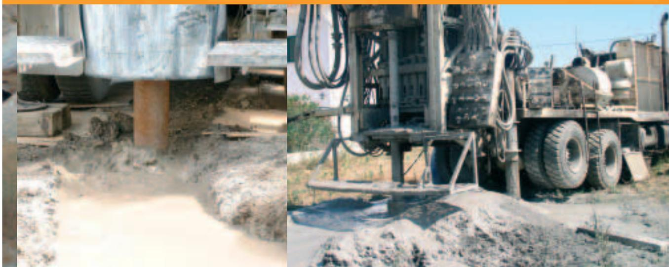
• As máquinas **INGERSOLL-RAND**, modelos **TH 100** e **TH 100A** podem executar furos de diversos diâmetros até à profundidade de 750 metros nos mais diversos tipos de solos, obtendo caudais por vezes superiores a 200 m<sup>3</sup>/h. Pelas suas características, estes modelos são utilizados pelas melhores empresas de sondagens. Dispomos ainda de diverso equipamento logístico de apoio às sondagens e transporte, assegurando atingir os objectivos empresariais e comerciais a que nos propomos.
